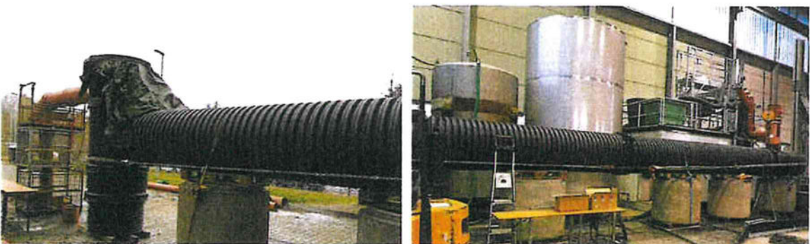
Abb. 3: Niederschlagswasserbehandlungsanlage Certaro 800/21 „begehbar“ aufgebaut im IKT-Prüfstand während der Versuchsdurchführung mit Blick (links) auf den Anlagenteil außerhalb der Halle mit Auslauf und Probenahmestelle und Blick (rechts) auf die Zudosierung in der Versuchshalle.
